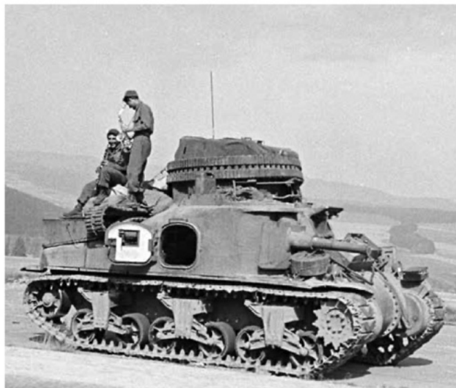
Een M3A1 CDL waarbij het geheim van de CDL-toren bewaard wordt door een canvas doek en een rupsband van een M2/M3 halftrups.
